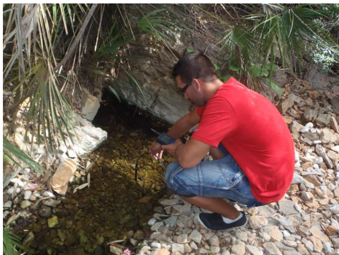
Fotografía 7.1. Medida de la temperatura y la conductividad eléctrica del agua en el nacimiento de Nagüeles
