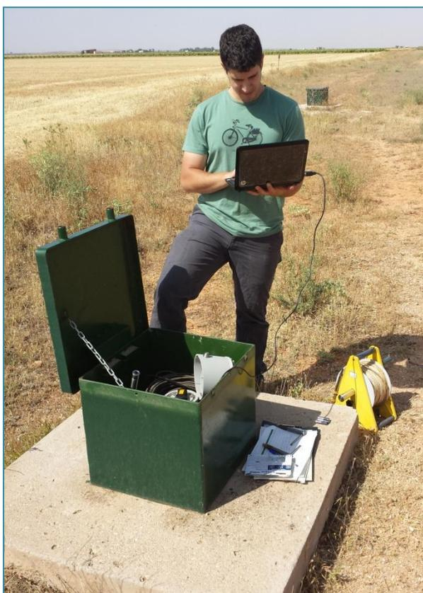
Figura 1: Medida del nivel piezométrico y descarga de datos (CHG). Fuente: Elaboración propia
