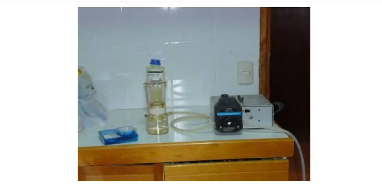
**Fotografía 2. Sistema de filtrado en terreno marca Merck**
