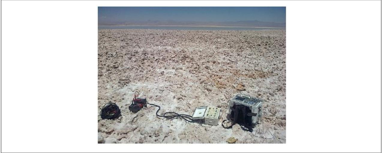
**Fotografía 3. Equipo de prospección geofísica electromagnética**
