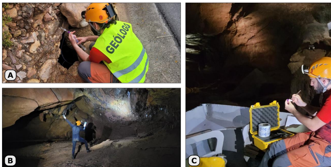
Figura 7.1. Toma de muestra de gases para su análisis isotópico y medida de concentración de CO 2 . A: Toma de muestras en la Sima del P.k. 17. B: Medida de concentración de CO 2 en la zona no visitable de las Coves de Sant Josep. C: Toma de muestras desde la barca en la zona visitable de las Coves de Sant Josep
