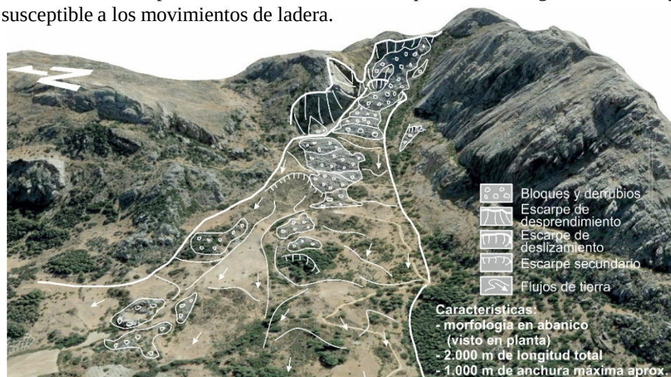
Figura 9. Esquema del deslizamiento del Hondonero. Imagen tomada de Google Earth.
