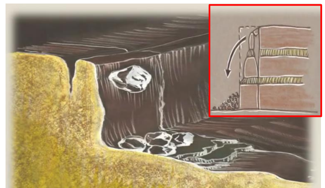
Figura 11. Caída de bloques relacionada con la existencia de fracturas verticales en las rocas duras. Modificado de I.E.S. Pérez de Guzmán (2017).
